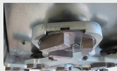
Быстросъемное крепление с подмагничиванием
