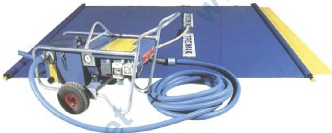
Вакуумный агрегат Р4001Е фирмы TREMIX используется в комплекте с вакуумматом TOP для снижения содержания воды на 20-25% в свежеложенном бетоне, что соответственно снижает водоцементное отношение и, следовательно, увеличивает прочность на сжатие и улучшает износостойкость поверхности бетона. Иснижаетс вероятность усадки бетона.
