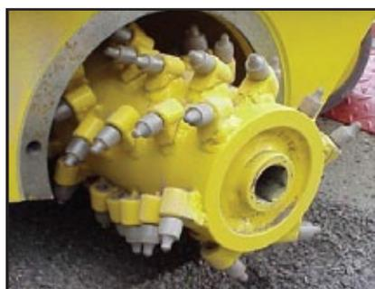
Сердцем машины являются высокопрочный барабан с установленными на нем вольфрамовыми резцами. Для обработки различных поверхностей могут применяться разные виды барабанов. Использование специального барабана позволяет удалять дорожную разметку. Имеется возможность нанесения насечек у кромок.
